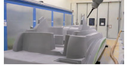
SC175 macun kullanılarak uygulanmış bir yat güvertesi modelinin CNC ile işlenerek hazırlanması
