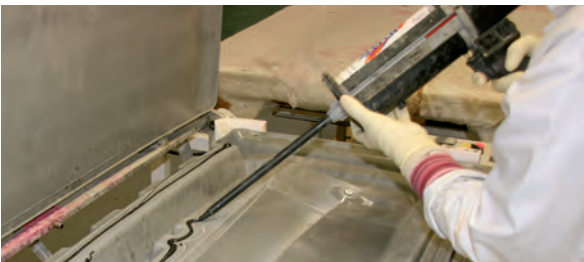
SMC parçalarının Adekit A280 ile yapıştırılması
