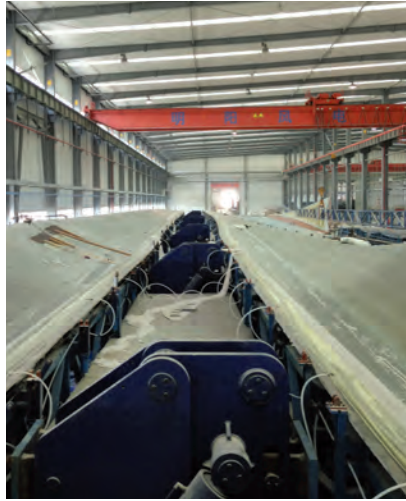
Biresin® CR131 vakum infüzyonu ile rüzgar türbini kanadı
