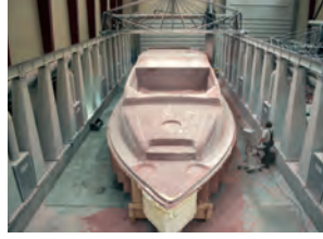
Bir yat güvertesinin CNC ile işlenerek hazırlanan homojen, eklentisiz, pürüzsüz yüzeyi
