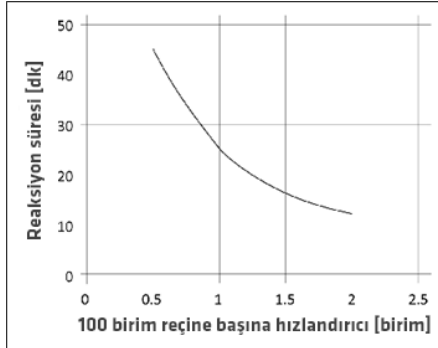
Diagram 2: Hızlandırıcı konsantrasyonuna bağlı olarak 100 °C'de reaksiyon süresi, Gelnorm (CQP021-5 / ISO 9396)
